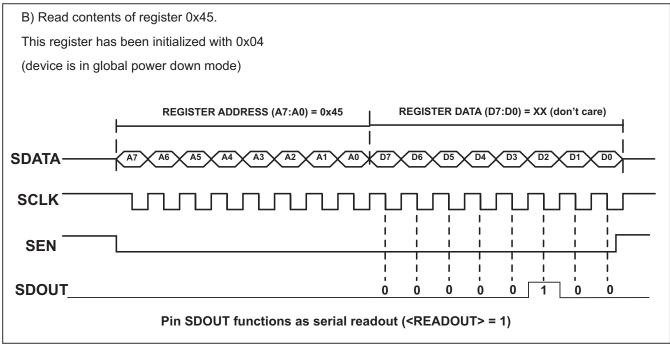
Figure 7. Serial Readout
